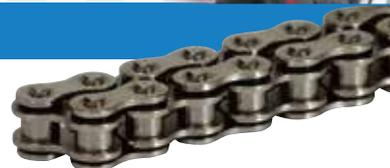
チェーンと言っても「鎖」ではなく、バイクに使われているのは「ローラーチェーン」って言って、動力を伝達するためのチェーンでして、バイクの左側、エンジンから後輪にかけてぐるっと一周してる金属のベルトみたいな部品です。ピン、ブッシュ、ローラー、プレートと呼ばれる部品を多数(100個~120個)組み合わせて、一本のベルトの様な見た目になってる部品です。
